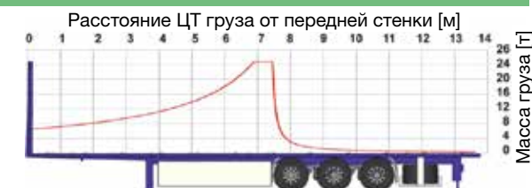
Рис.3. Пример схемы распределения груза – полуприцеп
