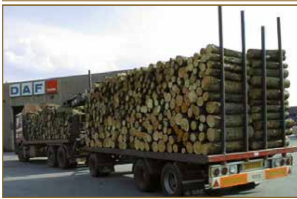
Рис. 69. Укладка лесоматериала поперек не рекомендуется!
