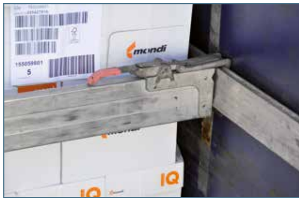
Рис. 44. Промежуточные блокирующие поперечины
