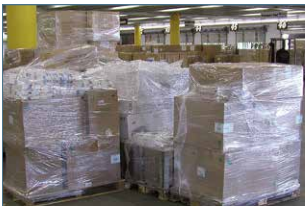
Рис. 52. Упаковка, затянутая растягивающейся пленкой
