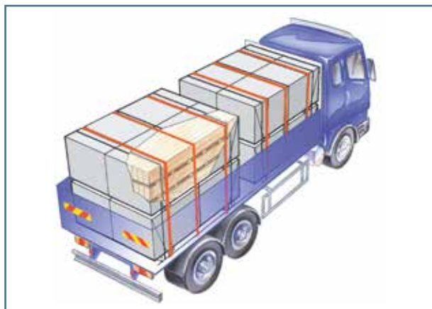
Рис. 51. Закрепленный полный груз пиломатериалов
