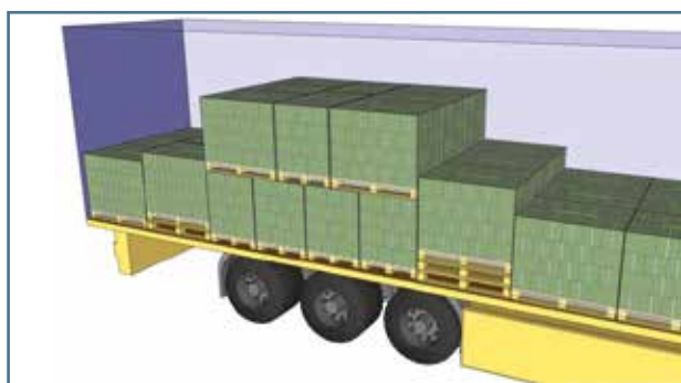
Рис. 17. Блокировка верхнего слоя за счет уступа в переднем направлении
