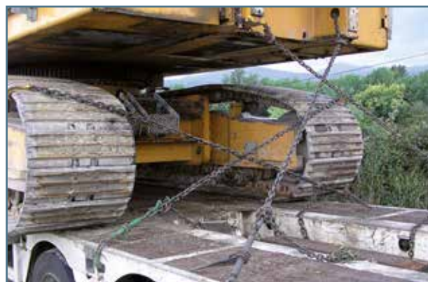
Рис. 39. Экскаватор, увязанный цепями по диагонали
