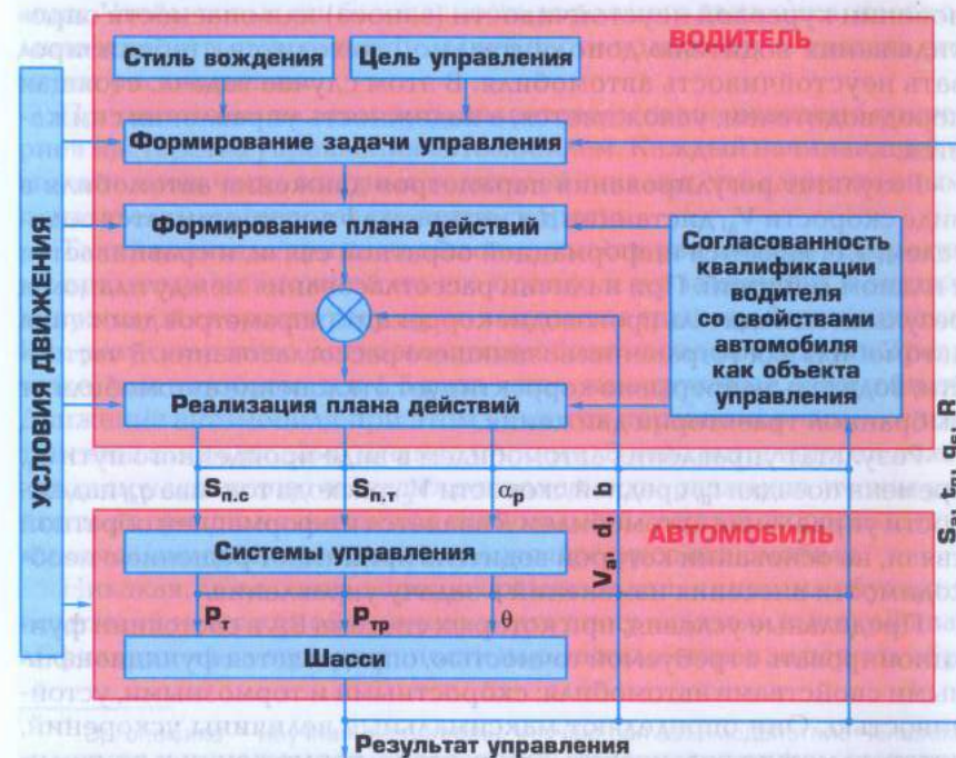
Рис. В.2 Структурная схема системы водитель—автомобиль
