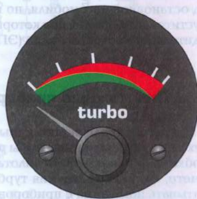
Рис. 3.26. Манометр для измерения давления турбонаддува:
