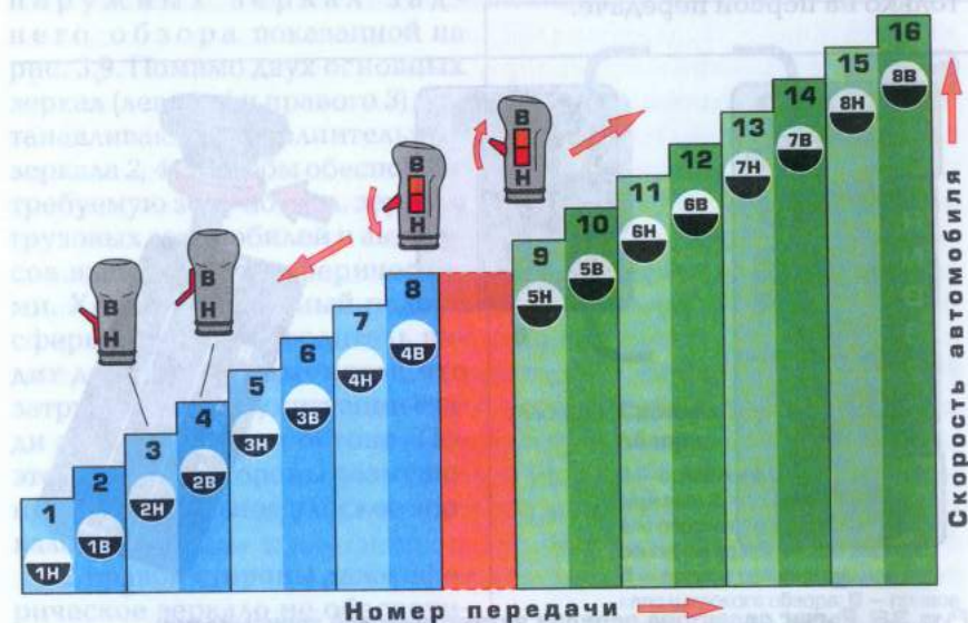
Рис. 3.7. Управление шестнадцатиступенчатой трансмиссией с демультипликатором и делителем
