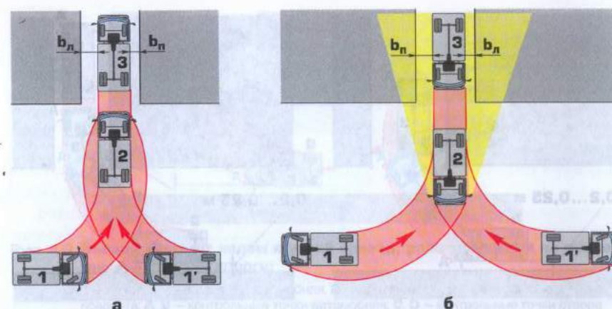
Рис. 4.7. Установка автомобиля перпендикулярно створу узкого проезда:
